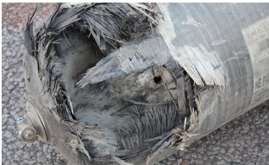
Bild 4: Tryckkärlsexplosion i biogasdriven sopbil (gastank av kolfiberkomposit).
