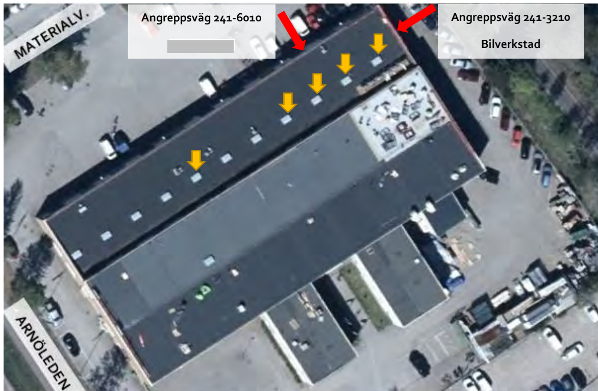
Figur 4: Flygfoto från 2019 (Nygis, 2020). De fem rökluckor som är markerade med gult öppnades i samband med branden.
