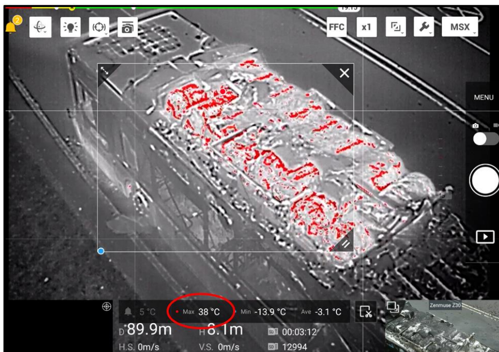
Bild 5 visar hur UAS genom IR-teknik fångat värmeutbredningen runt tankarna. Källa RSG.
