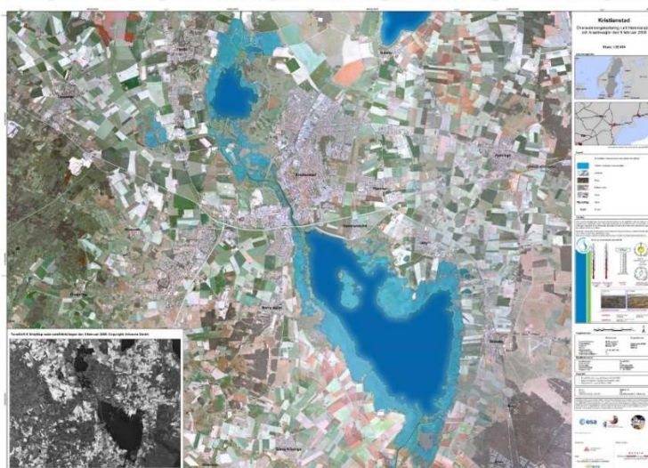
Figur 4 – Exempel på en översvämningsskartering över Kristianstad 2008 baserad på TSX radarbilder med 3 m upplösning (bilden i det nedra vänstra hörnet, från 2008-02-05). Det översvämmade området syns i ljusblått och sjöar och vattendrag syns i mörkblått. Bakgrundsbilden består av ortofoton.
