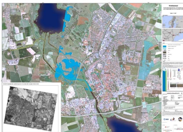
Figur 5 – Exempel på en översvämningsskartering över Kristianstad 2008 baserad på TSX radarbilder med 1 m upplösning (bilden i det nedra vänstra hörnet, från 2008-12-10). Det översvämmade området syns i ljusblått och sjöar och vattendrag syns i mörkblått. Bakgrundsbilden består av ortofoton.
