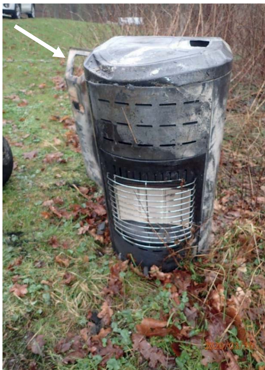
Bild 2. Gasolkaminen efter branden. Vid pilen visar den relativt lilla öppningen där man kan nå flaskventilen.
