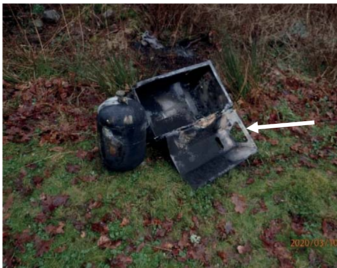
Bild 3. Gasolkamin med tillhörande gasolflaska efter branden. Pilen visar den relativt lilla öppningen där man kan nå flaskventilen.
