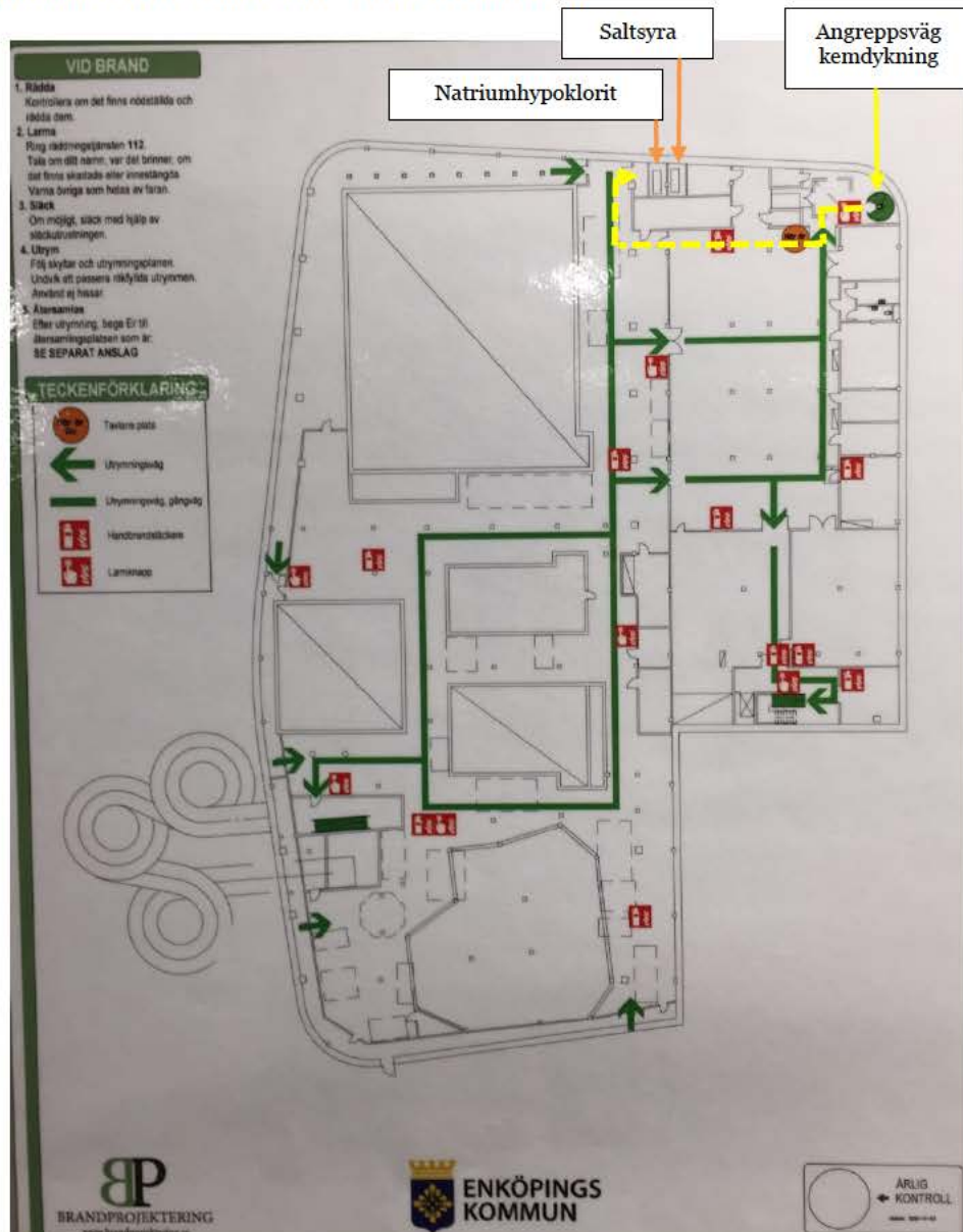
Bild 8. Källarplan. Rum för tank med natriumhypoklorit och saltsyra samt angreppsväg för kemdykarna markerade.
