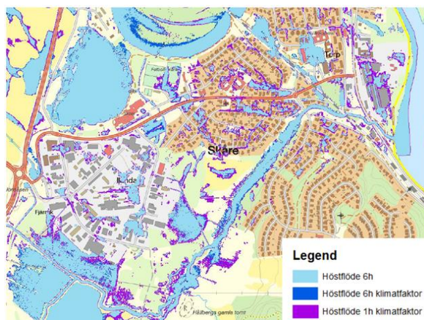
Figur 4. Hydraulisk simulering av maximalt översvämmat område under högt flöde i Skårenoret tillsammans med dagens 6h-skyfall, samt förväntade framtida påverkan av 1h- och 6h-skyfall genom att multiplicera en klimattfaktor på 1,25 till skyfallets volym
