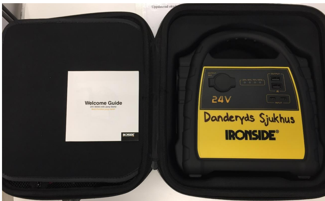
Nyinköpt Powerbank. Ironside, 3000mAh, med max strömstyrka på 400A.
