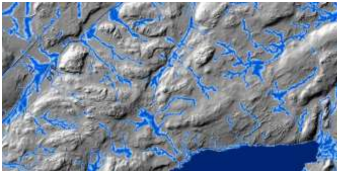
Figur 3: Exempel på Metrias Markfuktighetskarta. Mörkare blå färg indikerar högre markfuktighet
