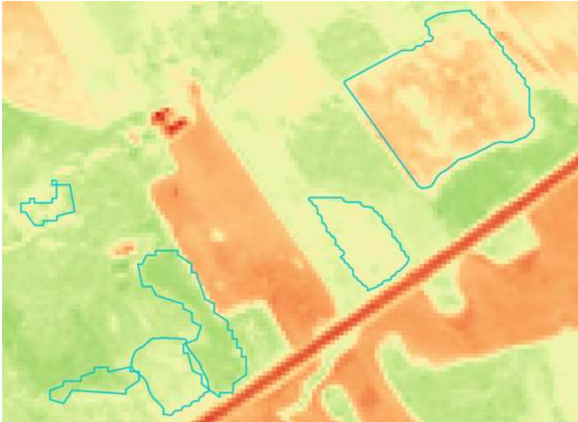
Figur 16: Analys av vegetation på hyggen. Bakgrunden visar median av NDVI-värden i en tidsserie med Sentinel 2-bilder. Skogsstyrelsens hyggesmask visas med blå ram. Hyggen med rödare färg har lägre andel vegetation, hyggen med grönare färg högre andel vegetation. Linköpings kommun, Östergötland
