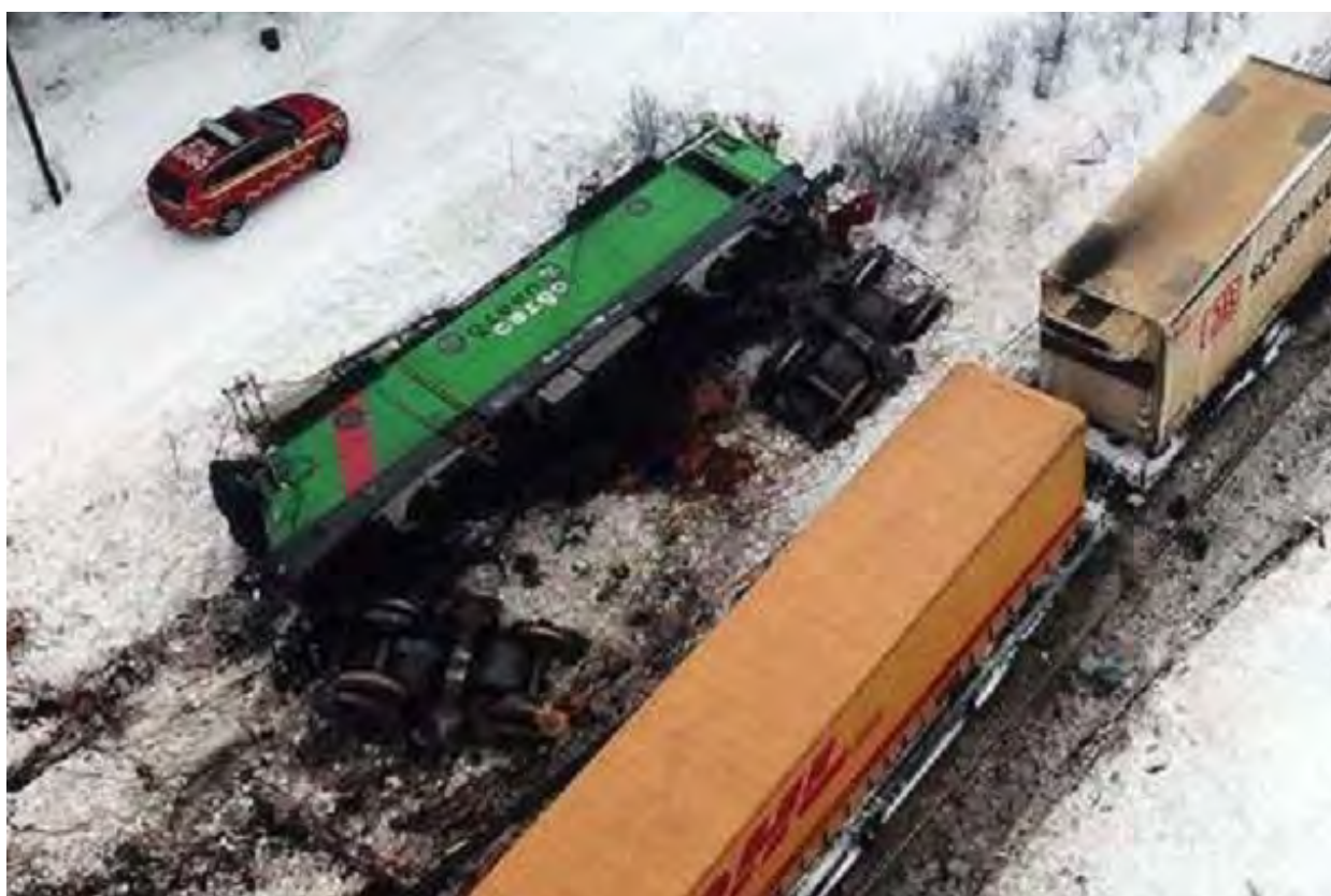
Bild 4: Här syns hur demolerad förarhytten är samt avslitna hjulaxlar.
