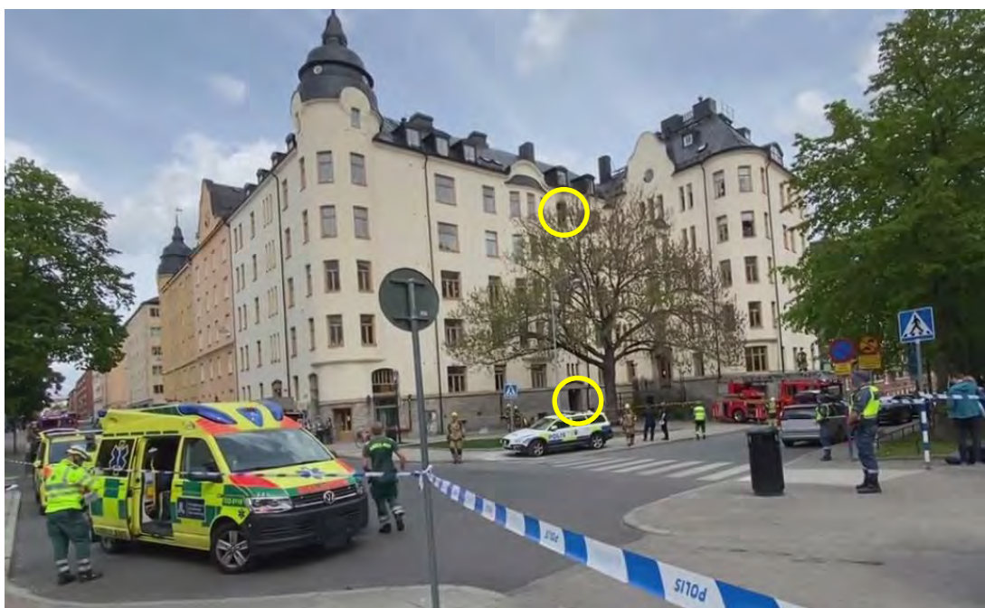
Bild SVT Nyheter. Fönster till brandlägenhet samt ingång till trapphuset gul markering. Träd framför fasad som försvårar stegresning.
