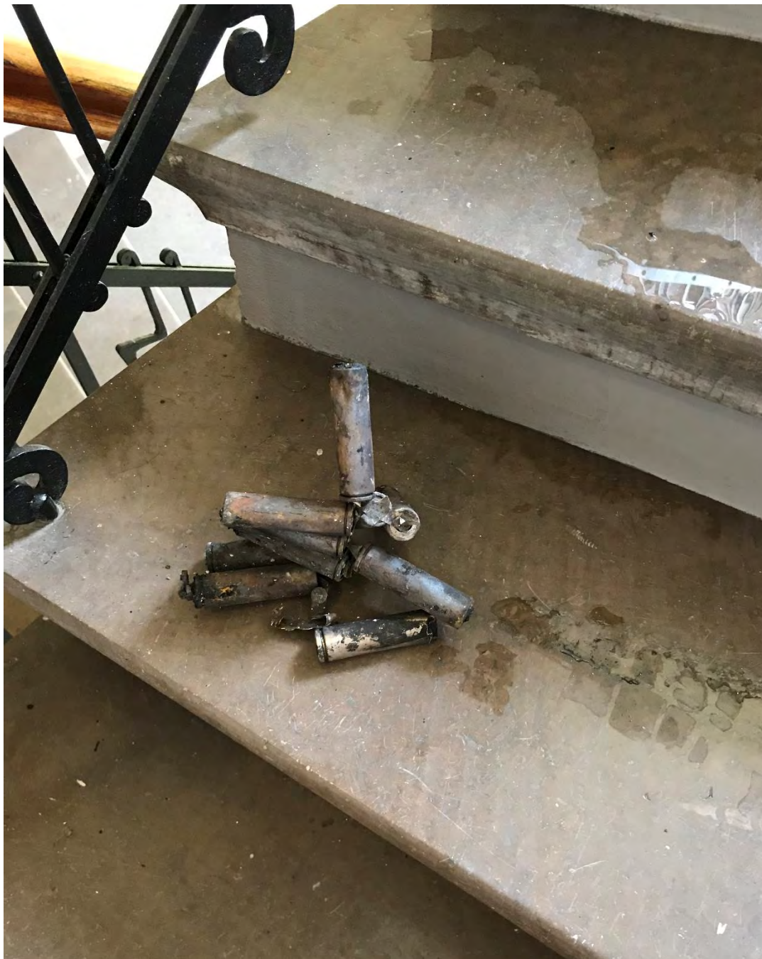
Bild SSBF. Rester av battericeller utplockade av rökdykare i trapphuset.
