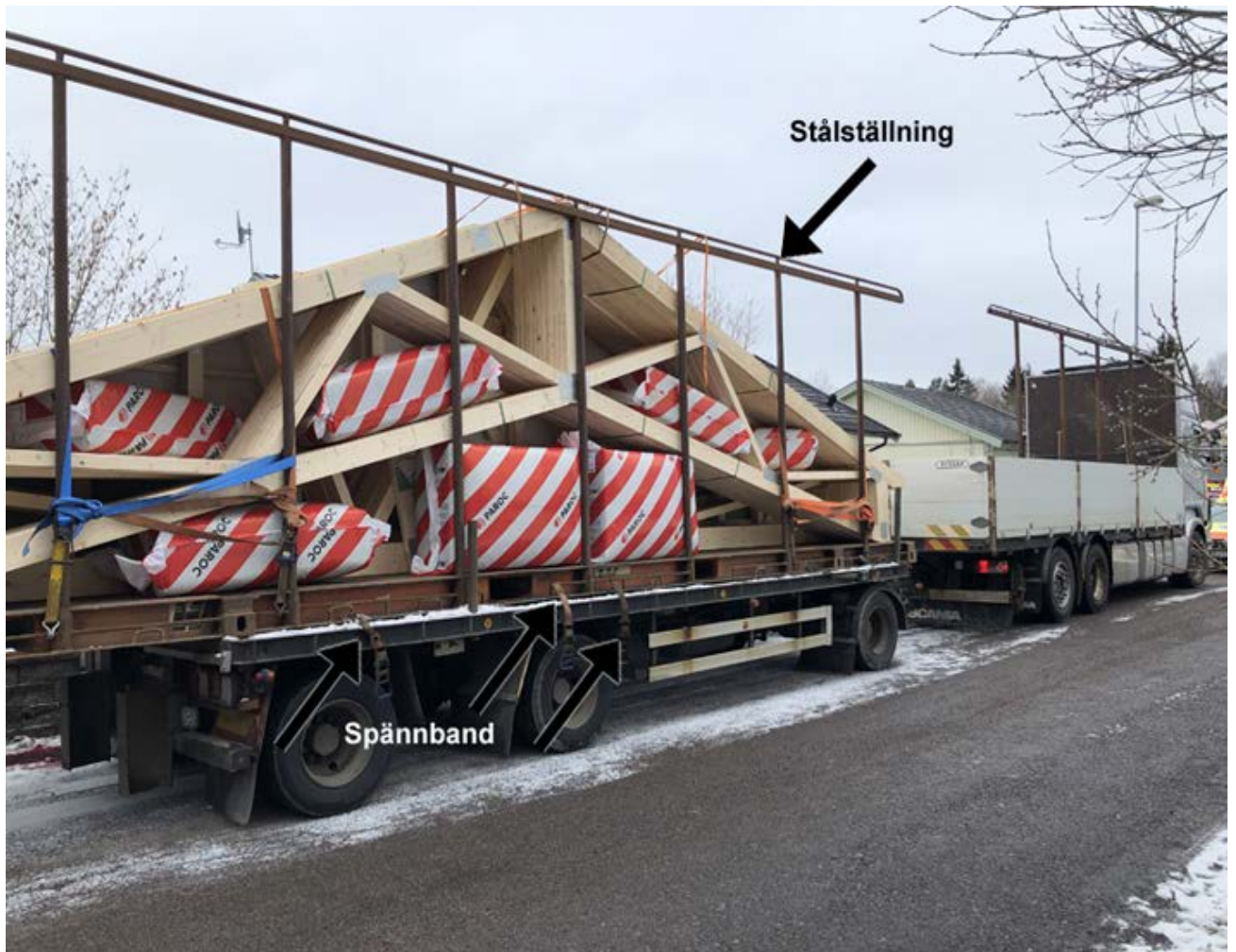
Bild 1. Stålställningen samt dom tre lossade spännbanden
