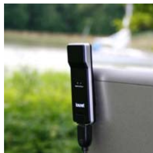
D-50 USB-modem 92x35x13 mm Vikt: 29g (källa: www.ice.net )
