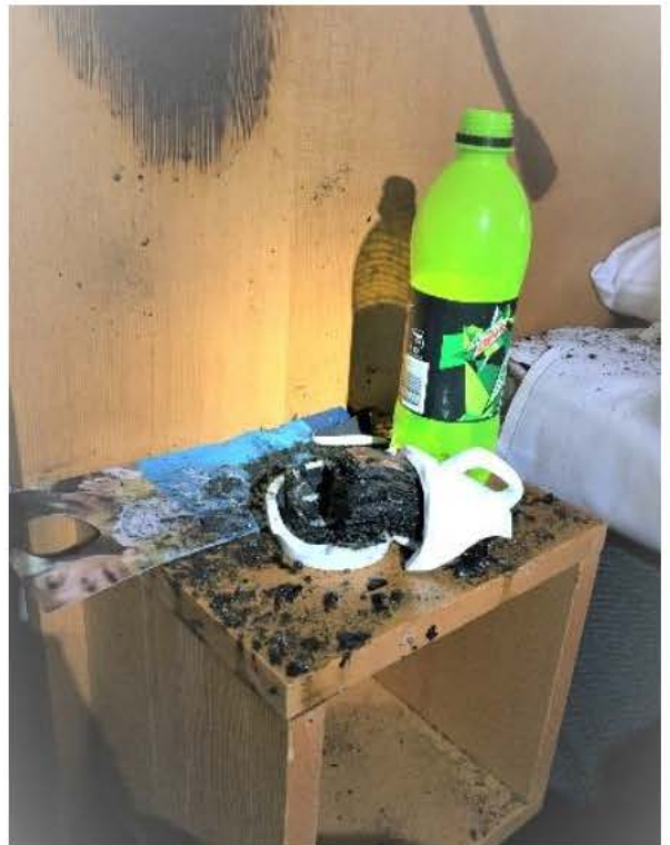
Batteriets placering vid laddningen
