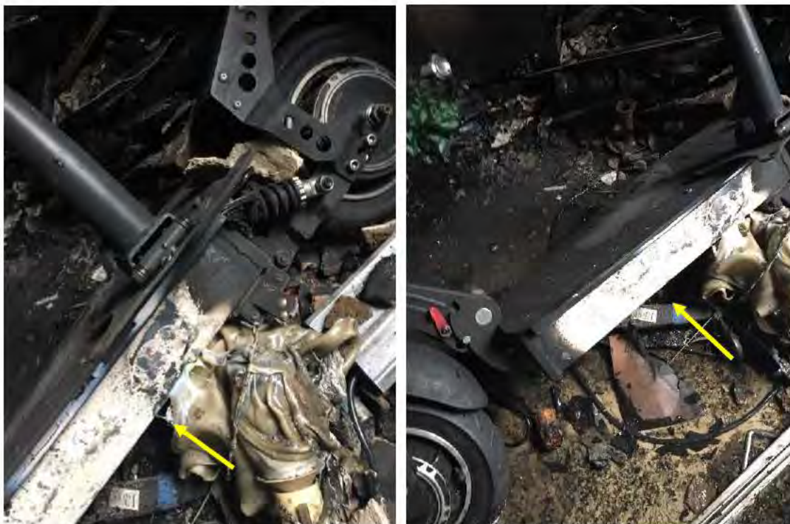
Bilder. El-sparkcykel som brunnit. Batteriets placering under el-sparkcykeln gul markering.
