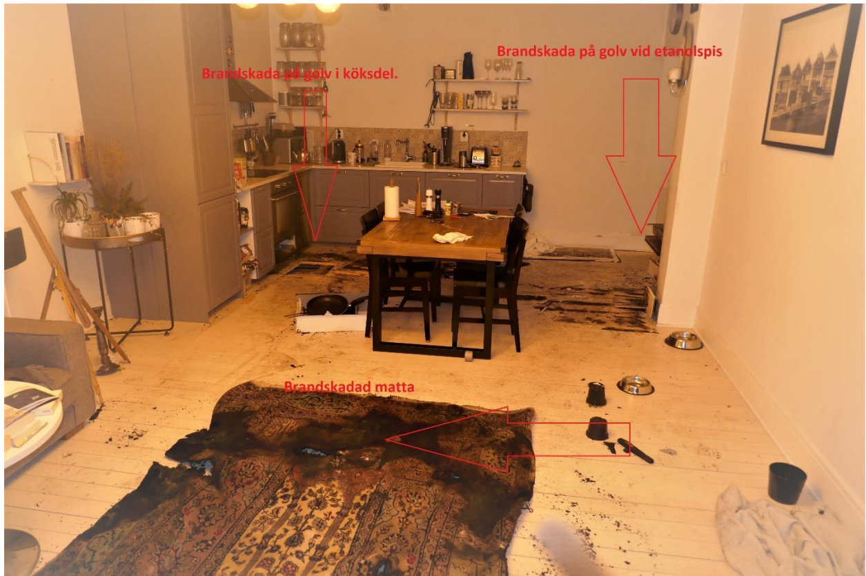
Foto 1. Brandskador i vardagsrum/kök visar spår av brandfarlig vätska.
