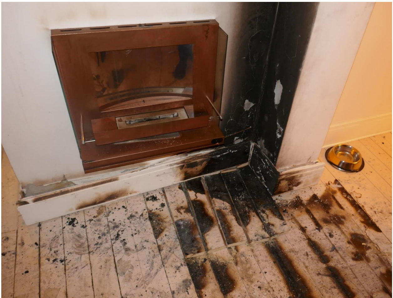
Foto 2. Brandskador vid etanolkamin. Brandskadorna på golvet visar spår av brandfarlig vätska som troligen spillts ut i samband med att vätskan i dunken antänts.
