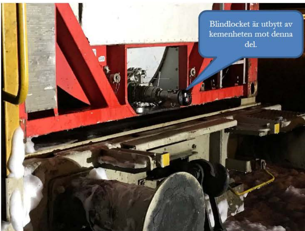
Bild 10: Tätningförsöket består av att byta ut blindlocket på flänsen mot en annan typ av fläns som finns i Kemenheten. Läckaget verkar ha upphört, men tyvärr visade det sig dagen efter att läckaget åter igen pågår.
