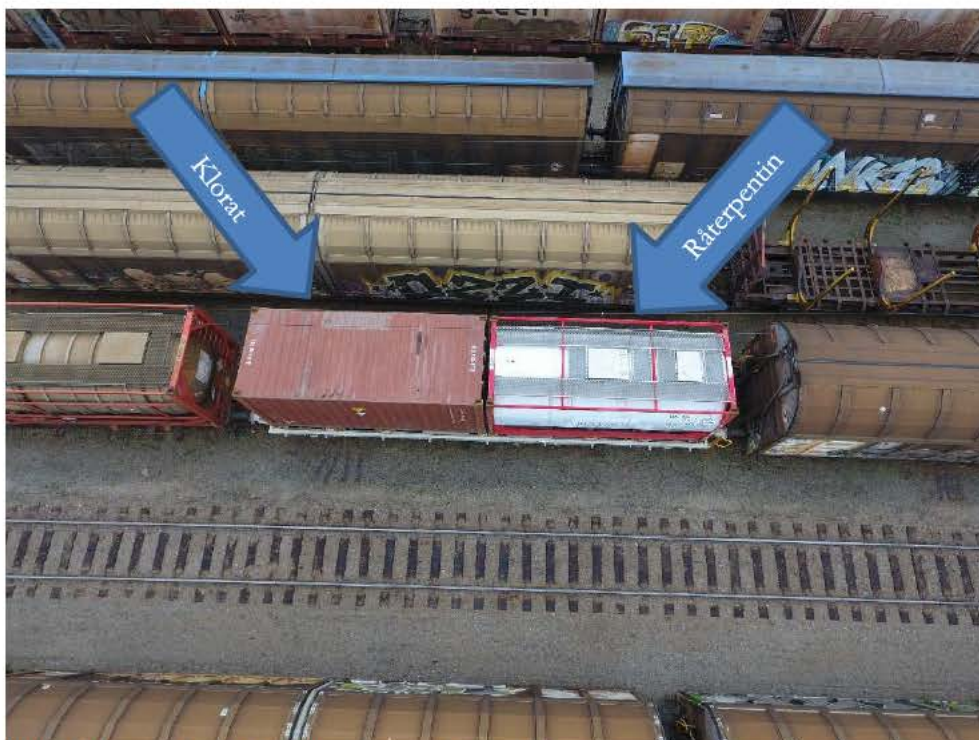
Bild 5: Här visas hur klorat och råterpentin lastats på samma järnvägsvagn
