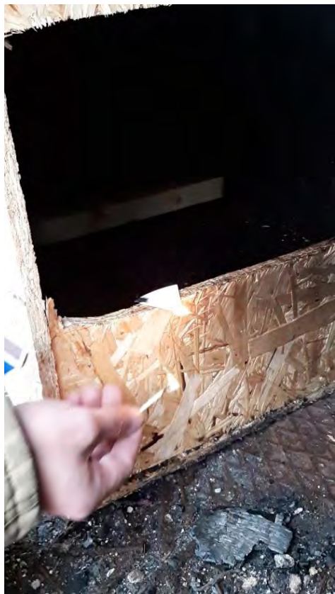
Bild 7. Plastmaterialet antändes med en tändsticka.
