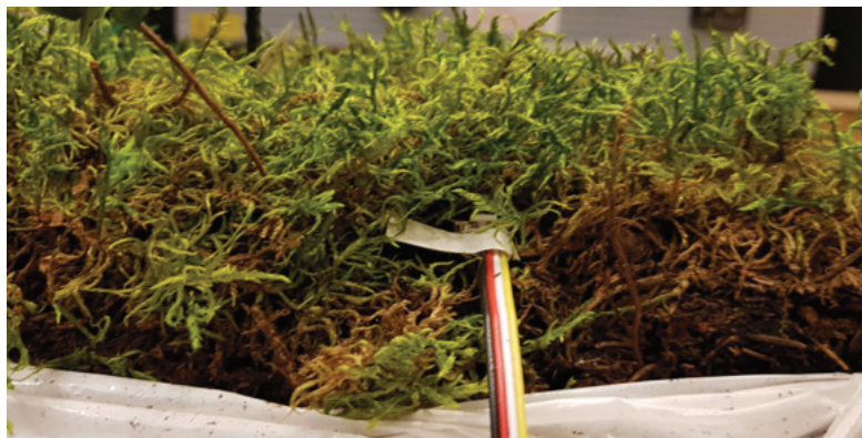
Figur 17. Sensorplaceringsdjup i mossan. Mossblocket i uttorkningsserie 2
