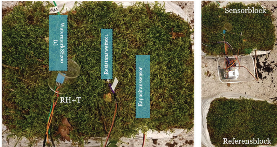
Figur 16. Sensorplacering för test 3, mossblocket i uttorkningsserie 2.
