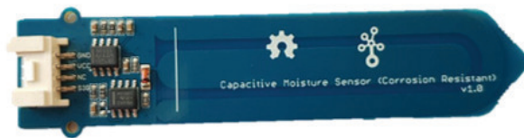
Figur 2. Seedstudios Kapacitansmätare. Sensorns längd/bredd är 92/23 mm. Tjockleken på själva sensorn är ca 2 mm.
