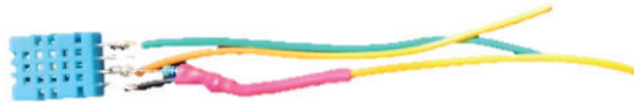
Figur 6. DHT11 RH-T-sensor. Storleken på sensorn är (längd x bredd x höjd) 16 x 13 x 6 mm.
