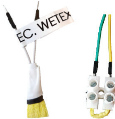
Figur 4. Resistansmätare med Wettex som referensmaterial. Vänster: Med ledpinnar. Höger: Med Wettexstrimla
