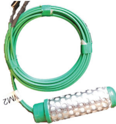
Figur 5. Watermark 200 SS. Storleken på sensorn är längd/diameter 83/22 mm.
