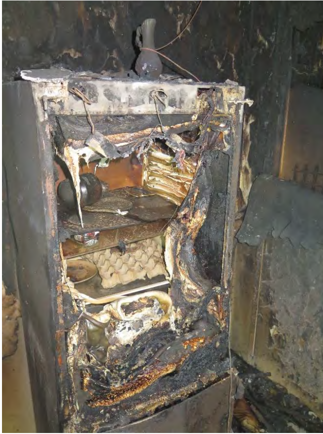
Figur 6. Bild på kylskåp som brunnit och där det isolerande materialet smält.
