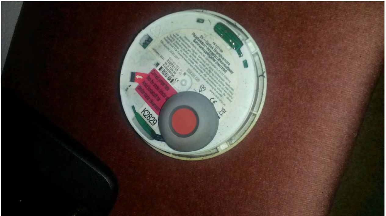
2. Brandvarnare med sensor som skickar signal till Malmö larmcentral
