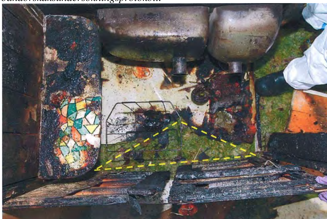
Bild 6 Rekonstruktion av köksskåpet, med primärbrand markerad i gult. Fotografi från polisens bandorskaksundersökningsprotokoll.
