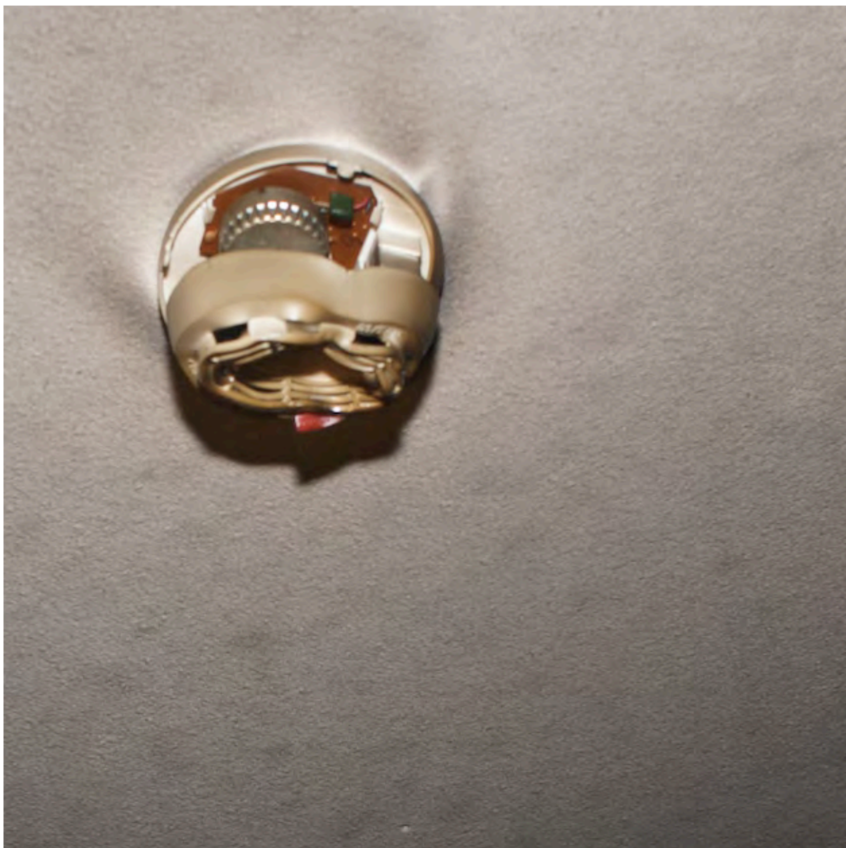
Bild 5. Brandvarnaren som inte fungerade.
