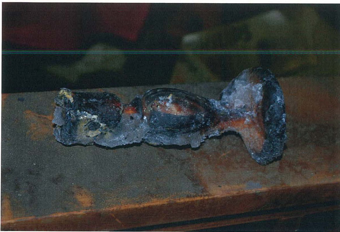
Bild 7: Skador på träljusstake
