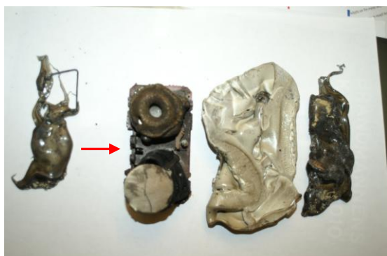
Resterna av brandvarnaren, pilen visar var batteriet skulle ha suttit
