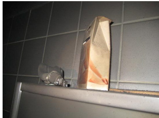
Smält hårsprayflaska och opåverkad pappersförpackning
