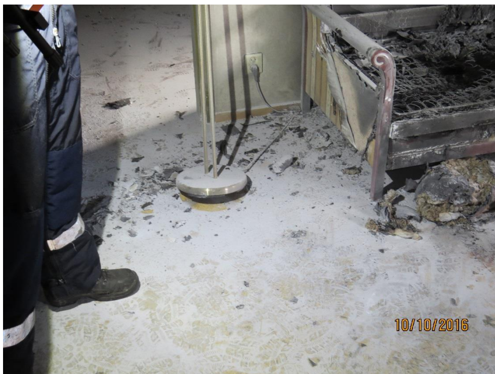
Bild 3: Visar lampan och sladden som går in bakom soffbenet.
