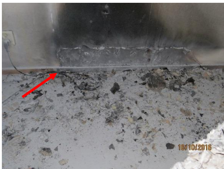
Bild 4: Den röda pilen visar var sladden legat i kläm bakom soffbenet och den brända slingan som legat under soffan.
