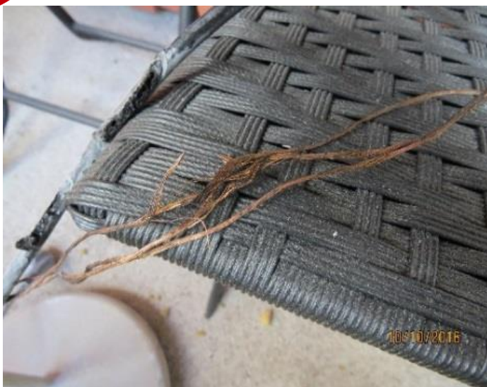
Bild 5: Skador på sladden.
