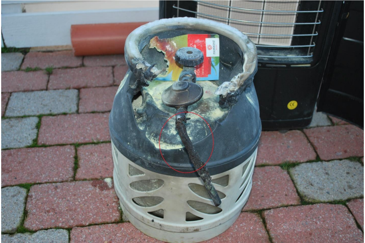
Foto 3. Gasolflaska med sprucken slang.
