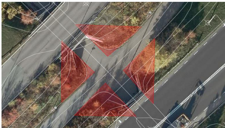
Bild 7 - Bild på sikttriangeln över aktuell korsning, se röd markering. På bilden kan man enkelt utläsa att sikttriangeln inte är uppfylld.
