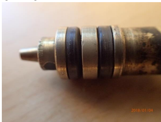
Bild 4 visar slitna o-ringar.
