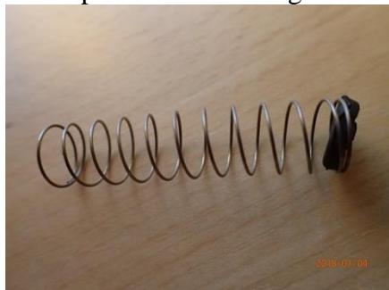
Bild 5 visar felaktig position på packning.
