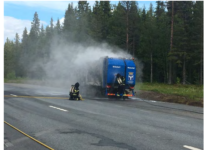
Eftersläckning av sopor mha. skärsläckare.
