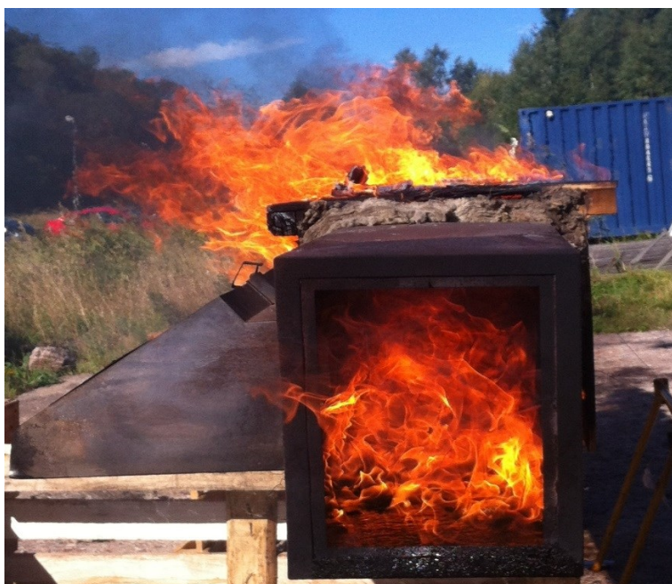
Stor mängd fett i kanalen kan göra att branden kan pågå länge.
