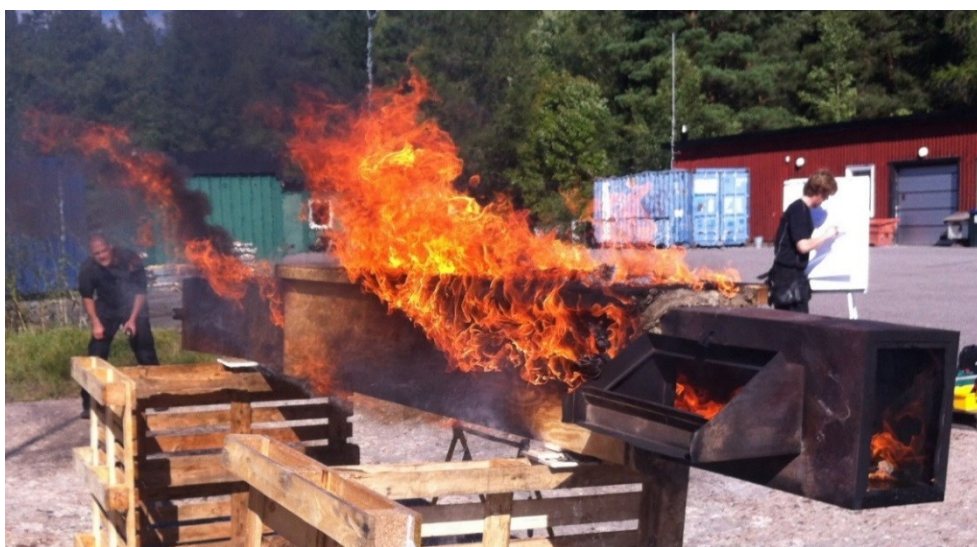
Värmen från branden har antänt de brännbara spånskivorna.
