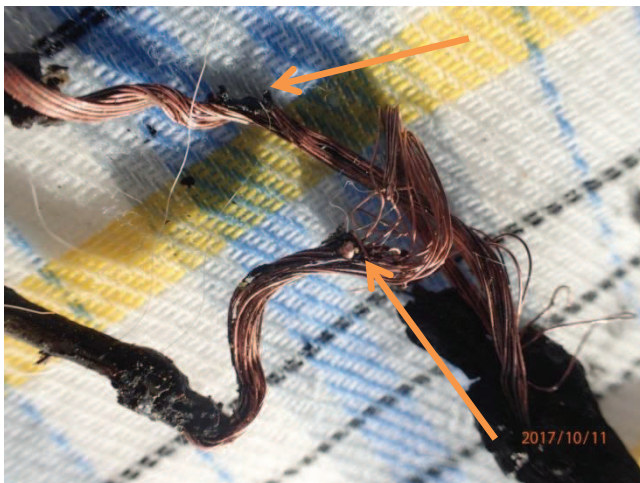
Bild 1 Trolig sekundär kortslutningsskada
