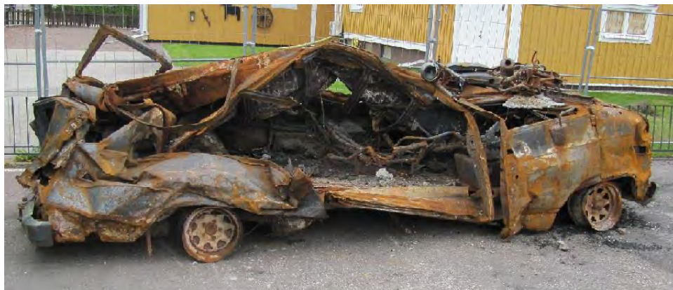
Bild 11: Resterna efter bilen där svetsningsarbetet hade utförts.
