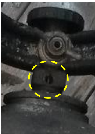
Flaskan med aktiverad smältsäkring
