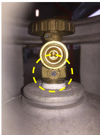
Exempel, opåverkad smältsäkring
