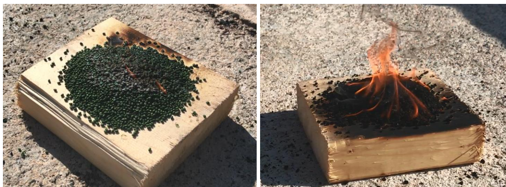
Enkelt brandförsök med TPE-gummi och SBR-gummi. Bilder från ca 30 sekunder efter antändning.
