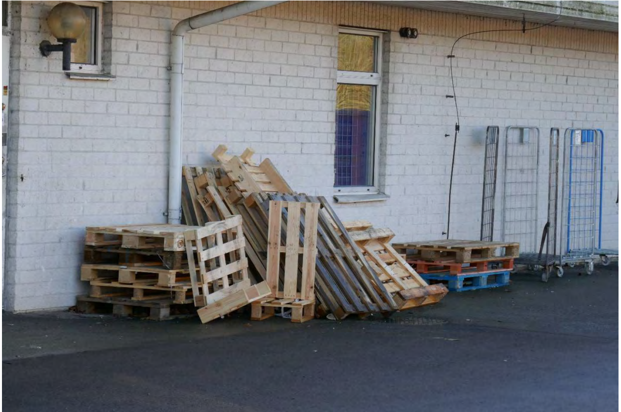
Bild 5. Brännbart material utanför restaurangen och bensinstationens fasad.
