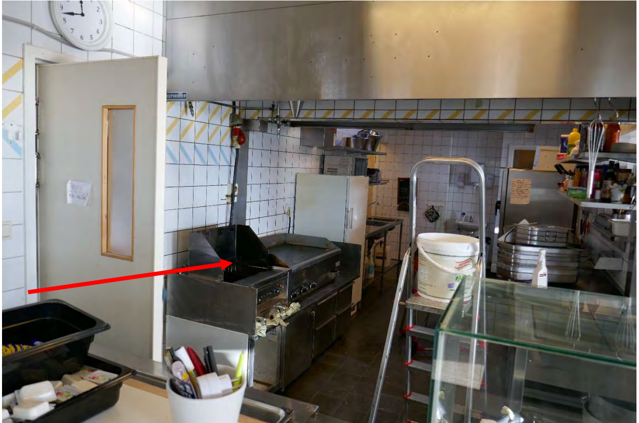
Bild 1. Fritösen vid pilen som det började brinna i.
