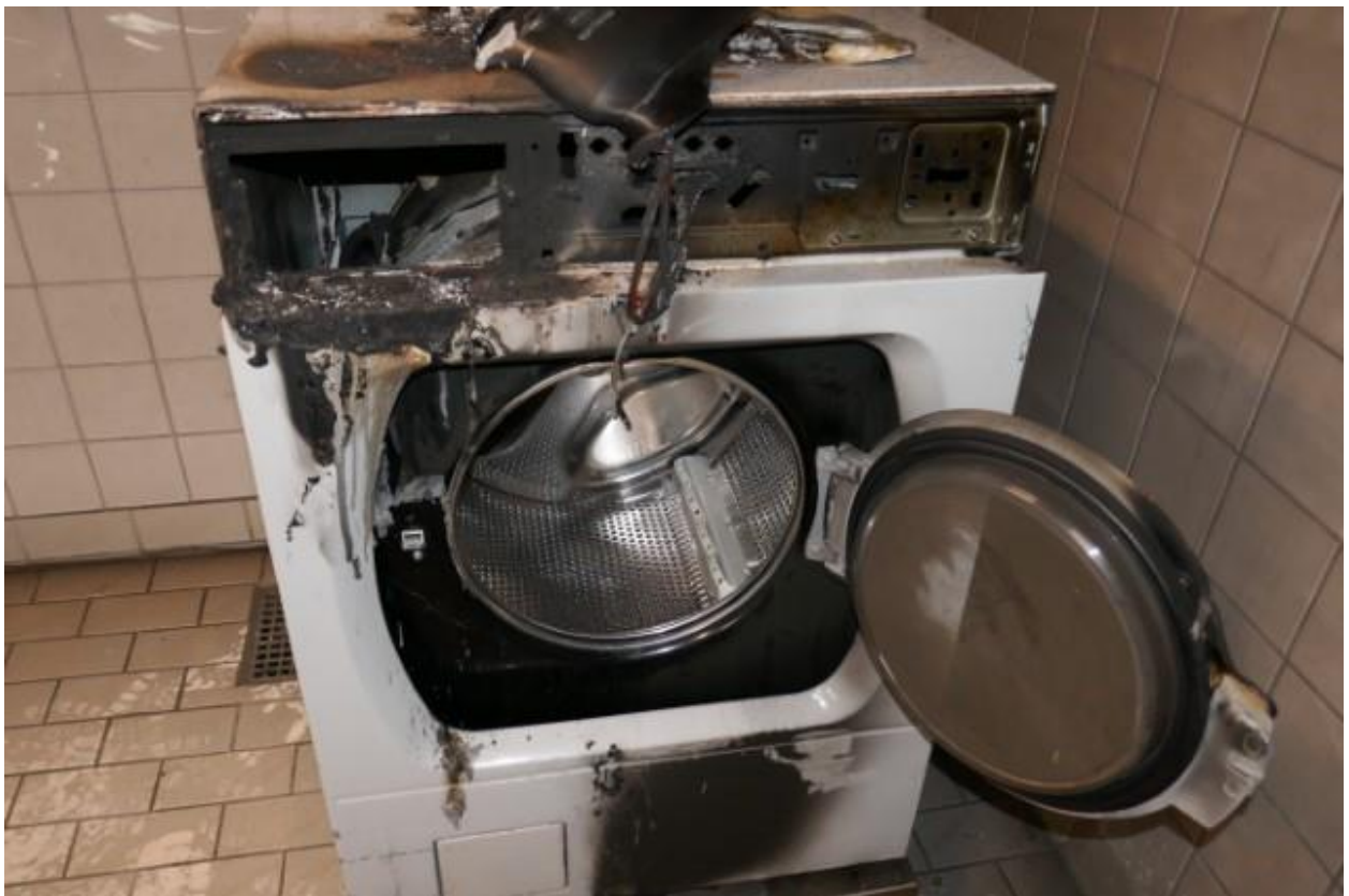
Foto 2. Kraftiga brandskador på elektroniken i tvättmaskinen.
