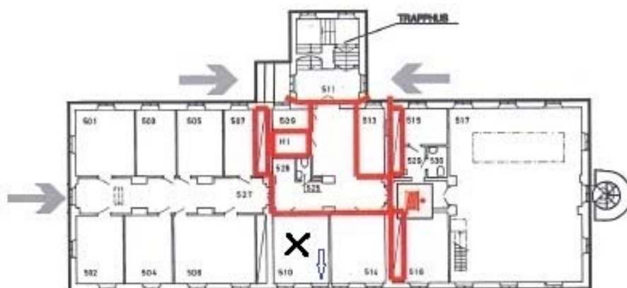
Figur 4. Planritning över våningsplan 5 med markerade brandcellsgränser. Brandrummet är markerat med svart kryss, blå pil visar brandspridningen ut genom fönstret.
