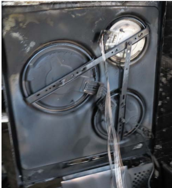
Bild 6, undersidan av spisen visar att en spisplatta inte har någon sotbeläggning, det kan bero på att plattan varit varm under branden
