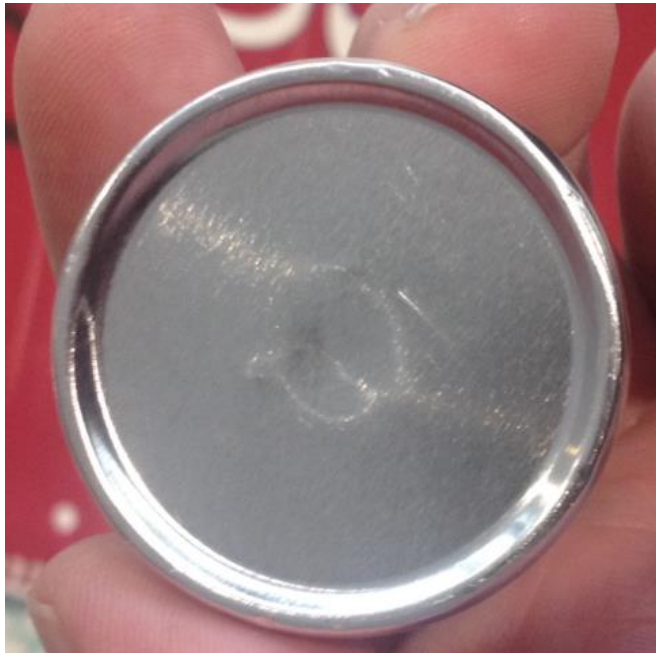
Figur 4: Undersidan av det, i tillbudet, inblandade värmeljuset
