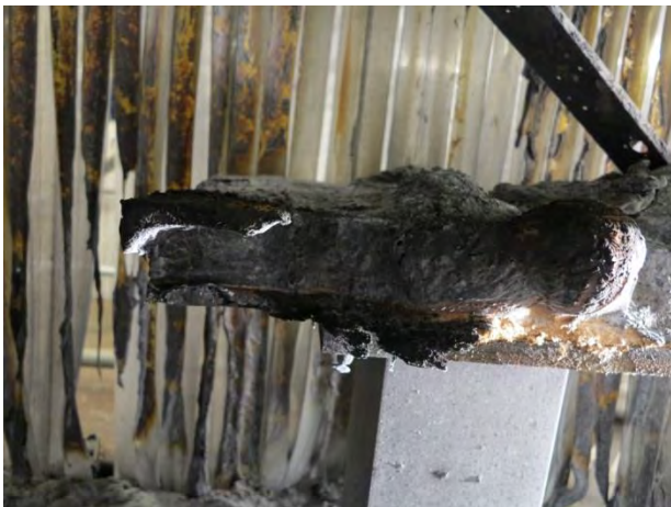
Figur 5: Brandstart med gnista mellan fräsverktyget och träskruven
