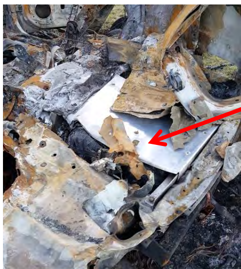
Figur 8. Bild från olycksplats, visar de tankar som satt kvar i bilen efter explosionen.
