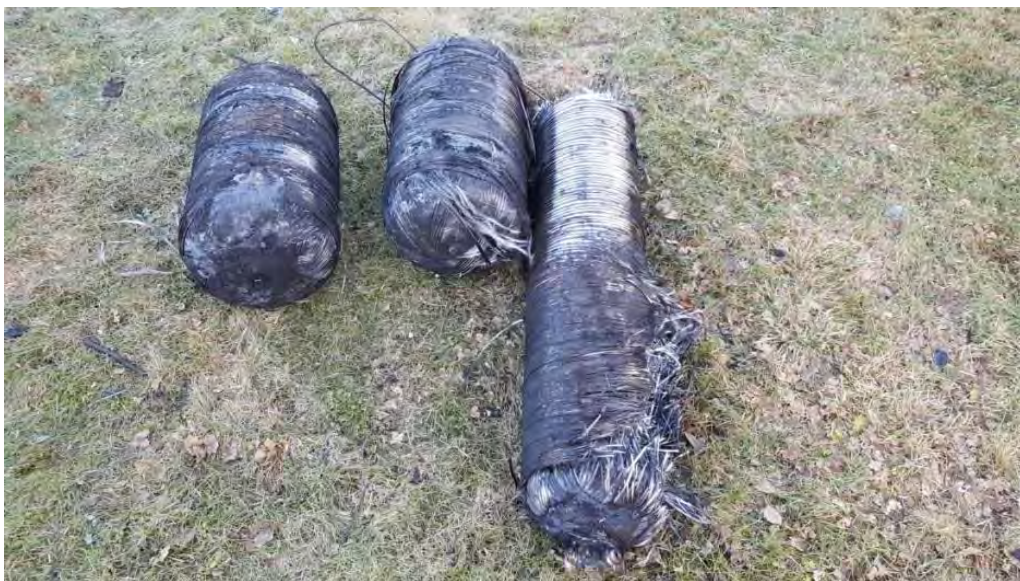
Figur 9. Visar de glas- och kolfiberbeklädda gastankarna som återfanns vid platsbesök, de två till vänster i bild är de som vid installation placerats under lastutrymmet.
