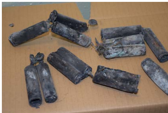
Bild 44 Brandskador på batterier
