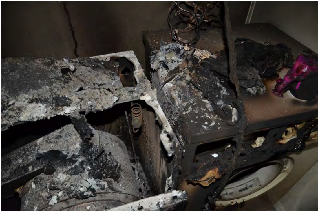
Höger bakre del av tvättmaskinen med de kraftigaste brandskadorna
