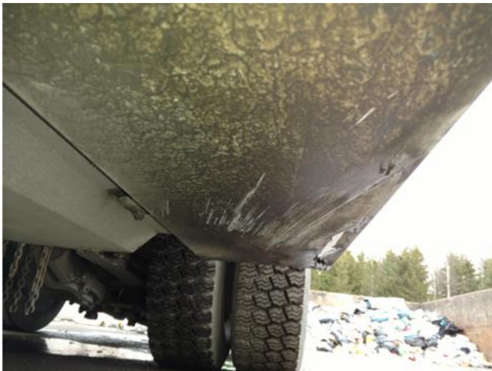
Figur 42 Färska skrapmärken på undersidan av den bakre delen av den vänstra skyddsplåten.
