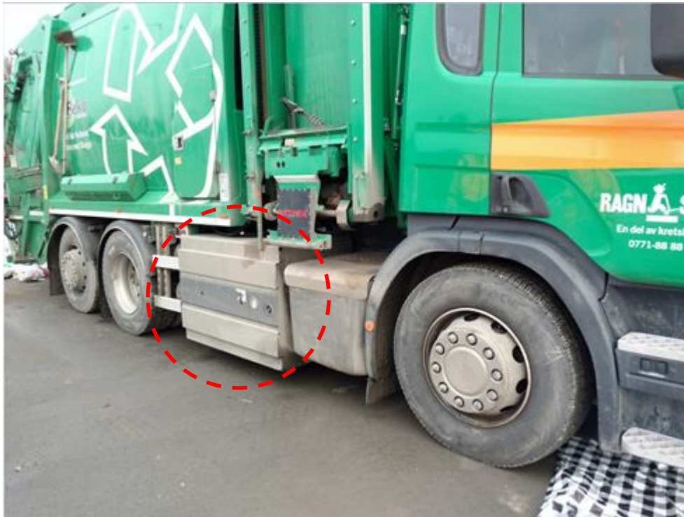
Figur 36 Även på fordonets högra sida är fordonsgastankarna (markerade med streckad linje) placerade lågt i förhållande till annan utrustning på fordonet. Det kan på fotot noteras att även det nedre "trappsteget" för insteg i fordonet är placerat högre upp än fordonsgastankarna.
