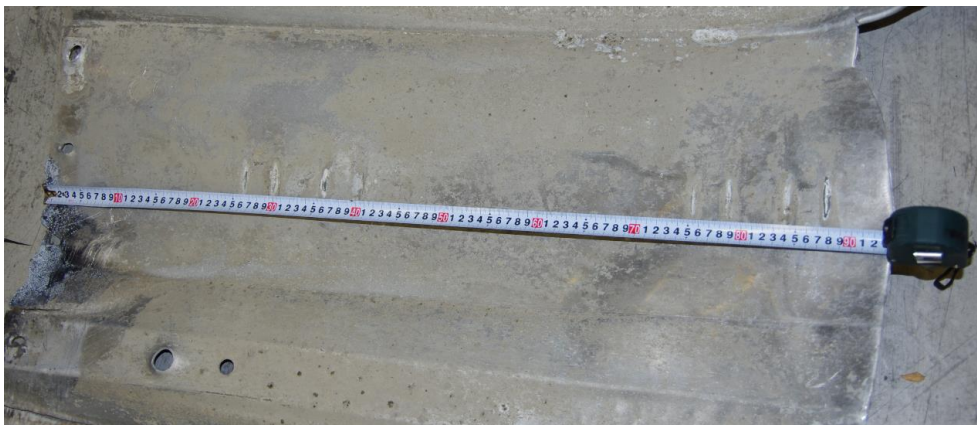
Figur 21 Insidan av skyddsplåten runt fordonskastankarna. På plåten finns åtta stycken repor vars inbördes avstånd stämmer överens med avståndet mellan fordonskastankarnas förankringsband.
