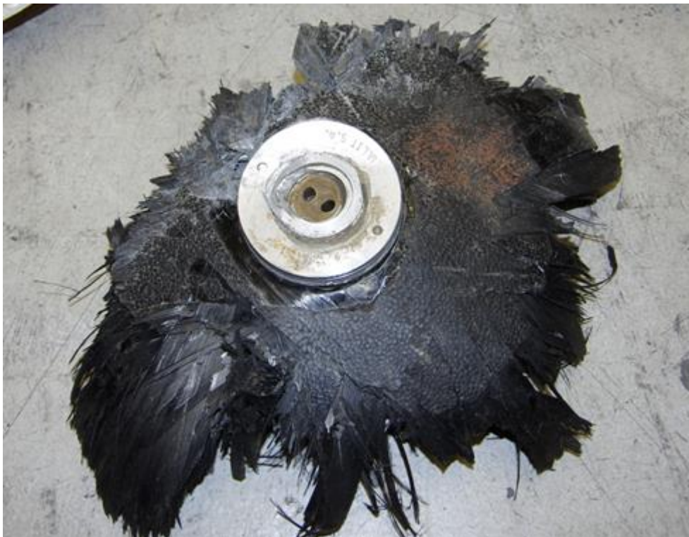
Figur 14 Tankkändens som flög iväg i samband med explosionen (utsida).
