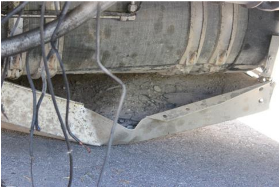
Figur 28 Foto på fordonskastankarna på fordonets högra sida. I skyddsplåten under tankarna har det ansamlats sand och grus (Foto: Polisen).
