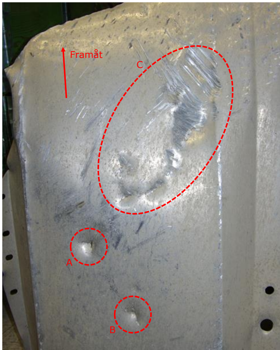
Figur 25 Motsvarande islagsmärken på skyddsplåtens utsida som i figur 24.
