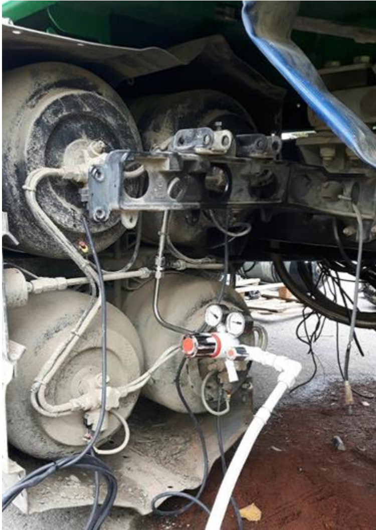
Figur 29 Foto på fordonsgastankarna på fordonets högra sida i samband med avfackling av gas efter explosionen (Foto: Scania).
