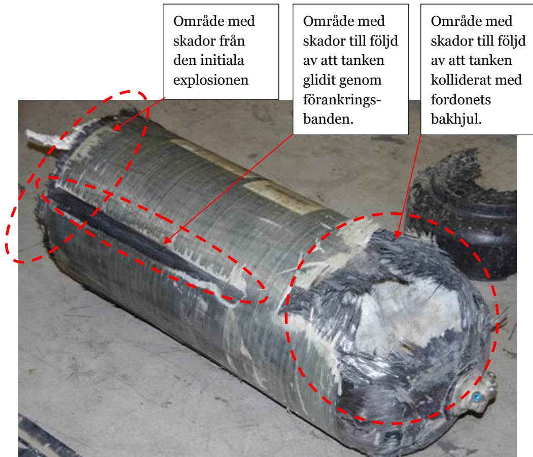
Figur 10 Skador på den fordonsgastank som exploderade initialt.
