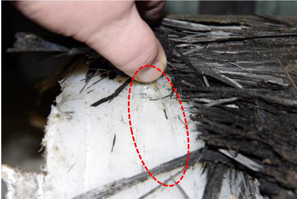
Figur 18 Skada på tankens inre gastäta skikt som sannolikt orsakats av ett förankringsband efter att den initiala explosionen inträffat.
