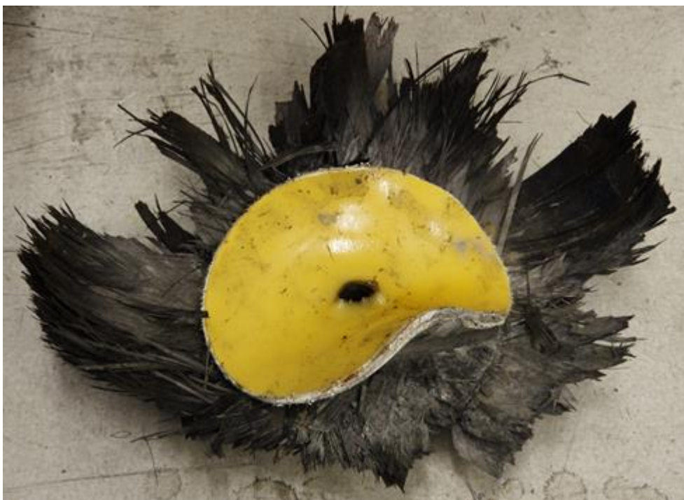
Figur 15 Tankkändens som flög iväg i samband med explosionen (insida).
