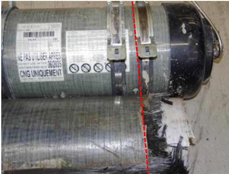
Figur 12 Skador på ena sidan av tanken i förhållande till placeringen av förankringsbanden.
