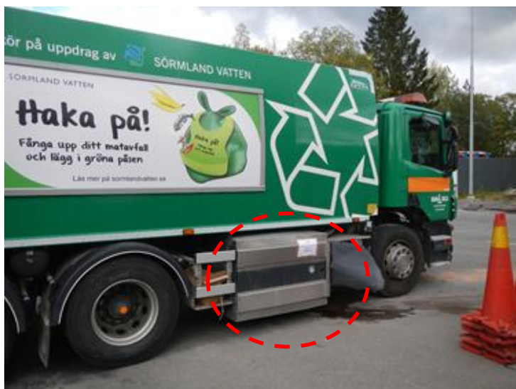
Figur 4 Foto på det aktuella olycksfordonets högra sida. Gastankarna är placerade i lådan mellan fordonets fram- och bakaxel.
