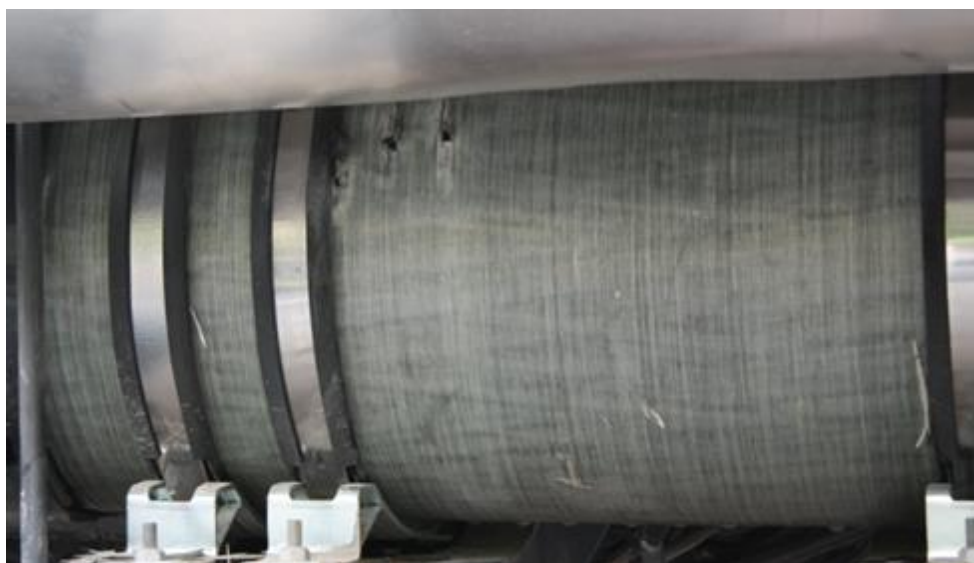
Figur 8 Tankarnas infästning i fordonet. Tre kulhål kan noteras i tankens överkant. De utstickande fibrer som är synliga på tanken härrör från andra tankar och har fastnat i samband med de explosioner som inträffade.
