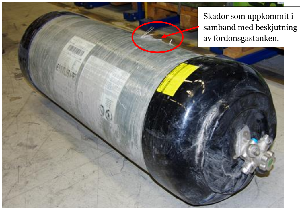
Figur 6 En av fordonsgastankarna från sopbilen som var relativt oskadade efter explosionen
