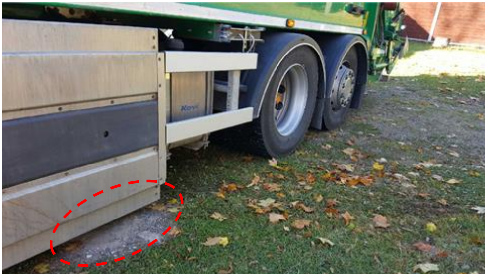
Figur 40 Vid hämtning av hushållsavfall är avståndet mellan skyddsplåtarna och marken ibland litet (Foto: Ragn-Sells AB) 3 .
