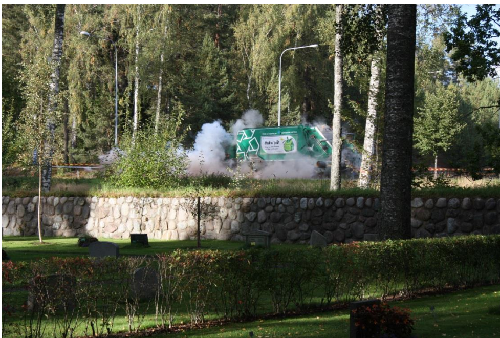
Figur 3 Den andra explosionen som inträffade vid beskjutning av tank 2 enligt figur 1. Delar från tanken flög omkring 100 m.
