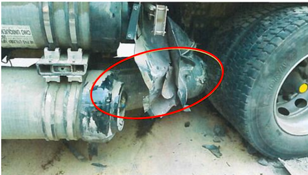
Figur 11 Den exploderade fordonsgastankens läge efter att ha kolliderat med fordonets bakhjul (Foto: Scania).
