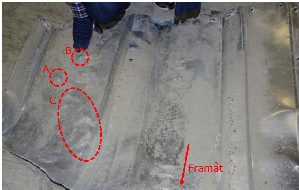
Figur 24 Bucklor från islag på den underliggande skyddsplåtens insida.
