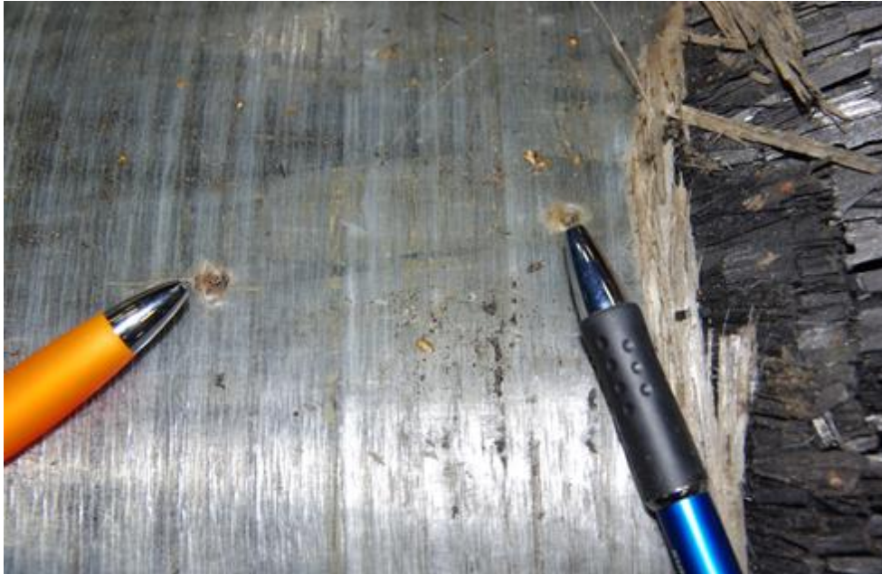
Figur 16 Exempel på mindre skador på fordonskastanken som exploderade initialt.
