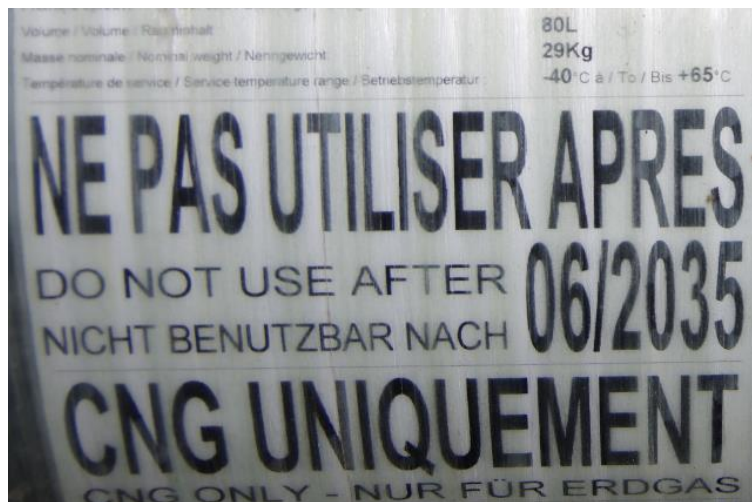
Figur 39 Märkning på en av olycksfordonets gastankar som anger sista användningsdag.
