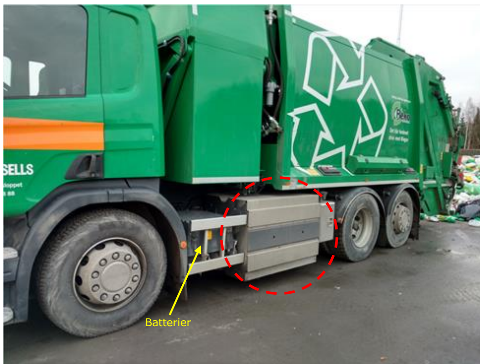
Figur 35 Foto på fordonets vänstra sida. Fordonsgastankarna (markerade med streckad linje) är placerade lågt i förhållande till annan utrustning på fordonet som exempelvis batterier och skåp för utrustning.
