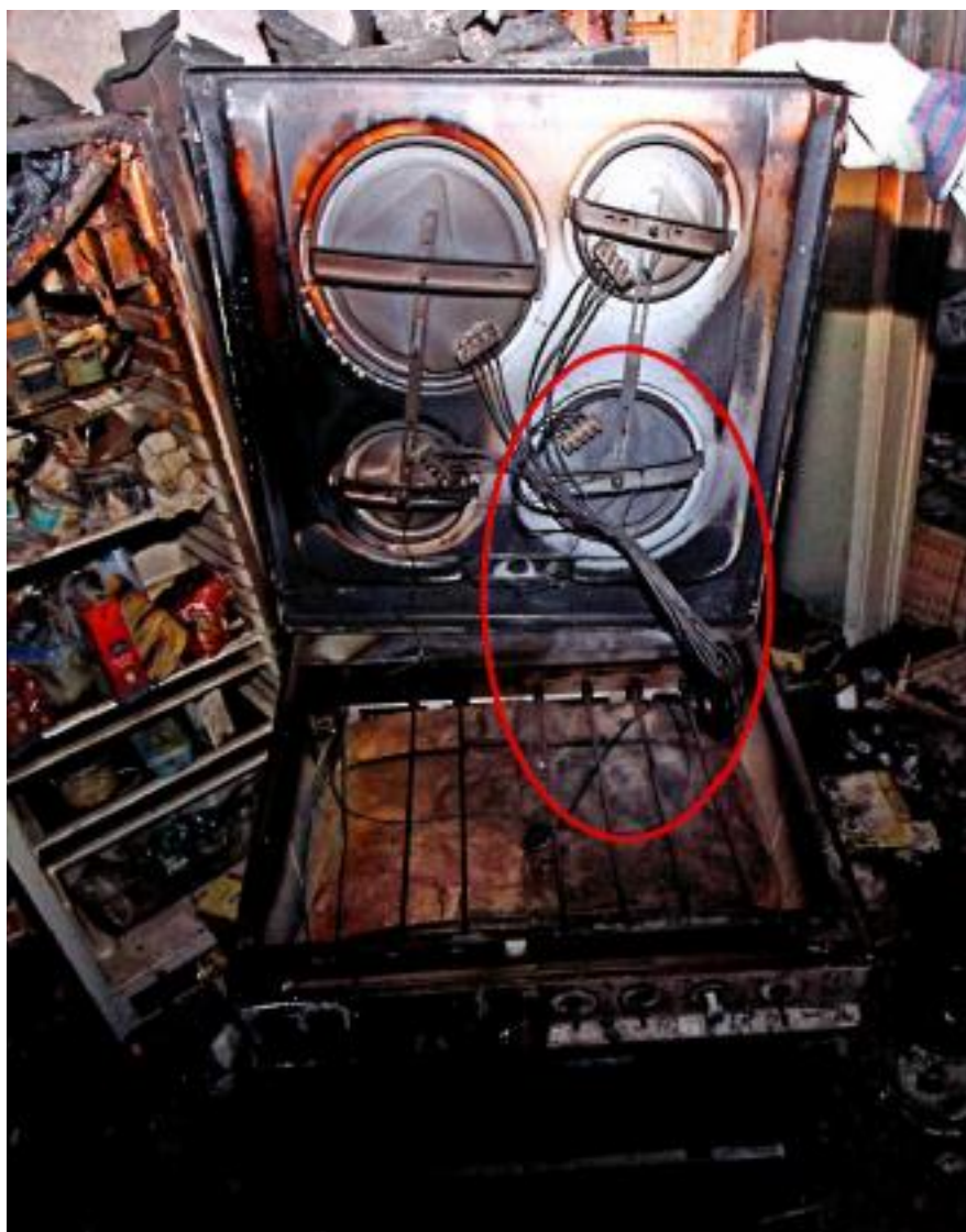
Figur 7 Sot avlagringar på isolering
