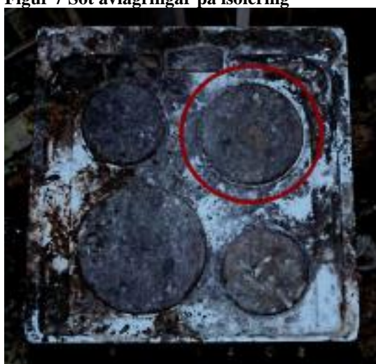
Figur 8 Sot avlagringar på spisplatta
