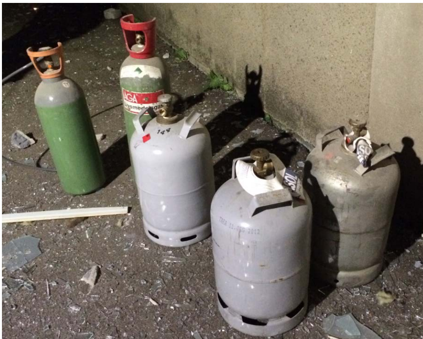
Bild 15. Gasflaskor från förrådet. Tre P11 med gasol och två Biogon C 10kg (koldioxid som livsmedelsgas). Foto: Västra Mälardalens Räddningstjänst
