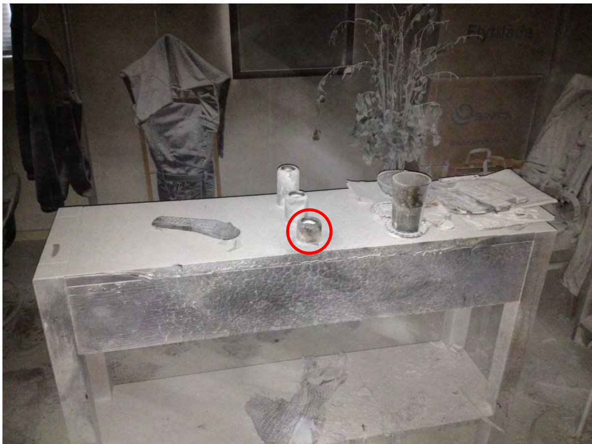
Figur 6: Bordet som var placerat intill sängen med de tre marmorljusstakarna. Den ljusstake som bedömdes ha brandskador har ringats in.
