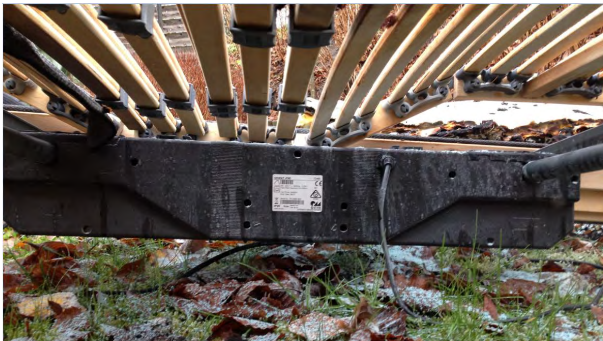
Figur 3: Sängens motor utan några synliga brandskador.
