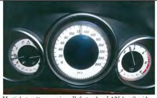
Hastighetsmätarens visarmål fastnade på 125 km/h vid kollisionen och enligt teknikernas bedömning, grundat på erfarenhet, är det mycket troligt fordonets hastighet vid kollisionen. Polisens foto.
