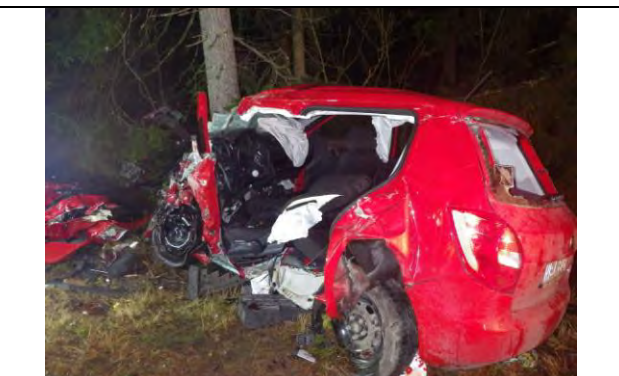
Här har fordonet som den omkomna kvinnan färdades i ställts på alla fyra hjulen, A/B stolpe och dörrarna klippts bort och förarsätet fällts bakåt. Räddningstjänstens foto
