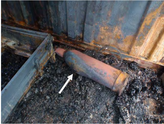
Bild 3. En sprucken acetylenflaska som hittades längst bak i mittenutrymmet.
